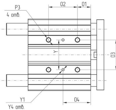
ЦИЛИНДРЫ ПНЕВМАТИЧЕСКИЕ СО ВСТРОЕННЫМИ НАПРАВЛЯЮЩИМИ СЕРИЯ QSTE
